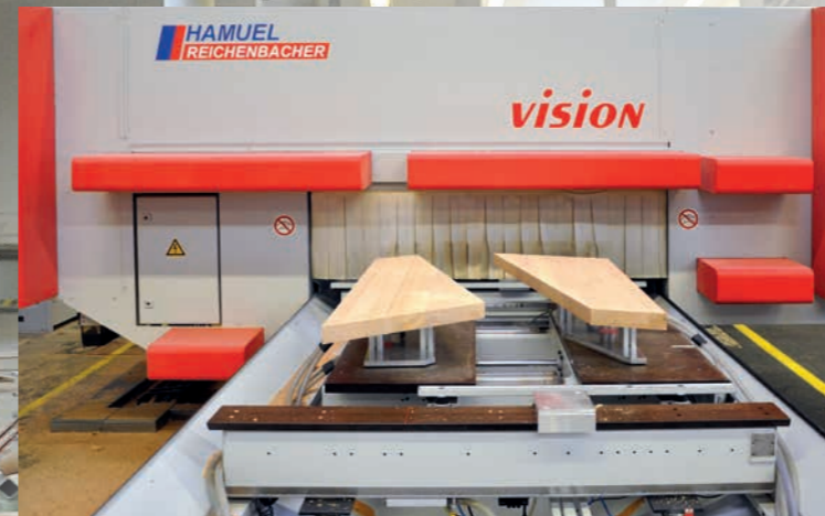
CNC-Bearbeitungszentrum VISION-II-ST Sprint mit fertig gefrästen Treppenstufen.
