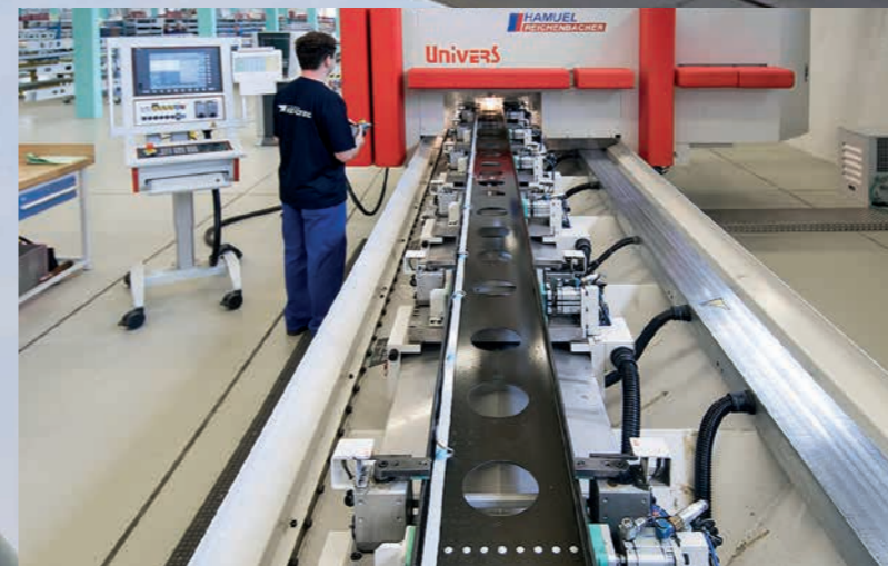
Die Anlage ermöglicht die 5-Achsen-CNC-Bearbeitung mit hoher Maß- und Wiederholgenauigkeit.
