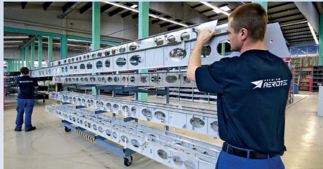
Zahlreiche Bohrungen in den Fußbodenprofilen sind notwendig für die Kabelausparungen im Fußbodengerüst.
