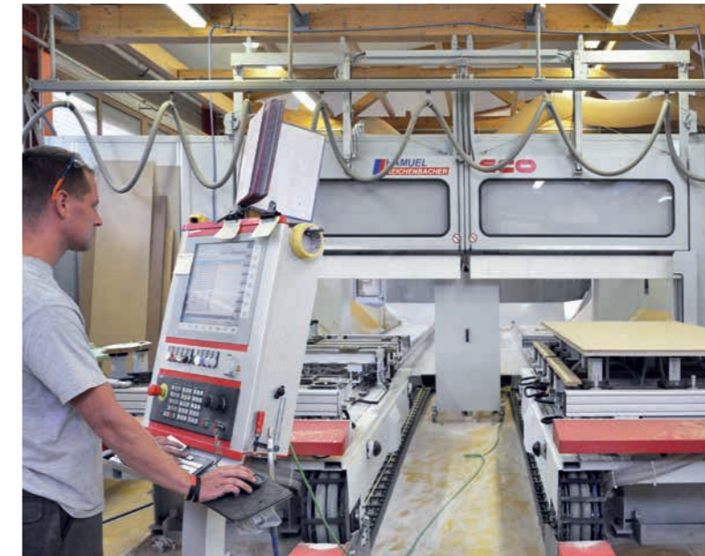
Das 5-Achs-Bearbeitungszentrum ECO-1232-B Sprint von Reichenbacher ist mit feststehendem 2-Ständer-Portal und zwei getrennt fahrbaren Bearbeitungstischen konzipiert.
