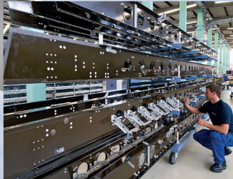
Schwere H-Profilträger für das Fußbodengerüst.
