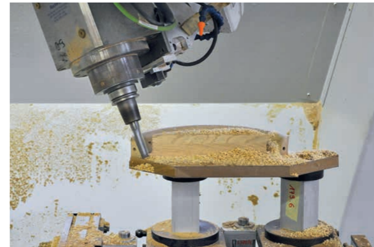
Die beiden 5-Achs-Aggregate verfügen jeweils über eine 24-kW-Spindel mit Drehmomentstütze.
